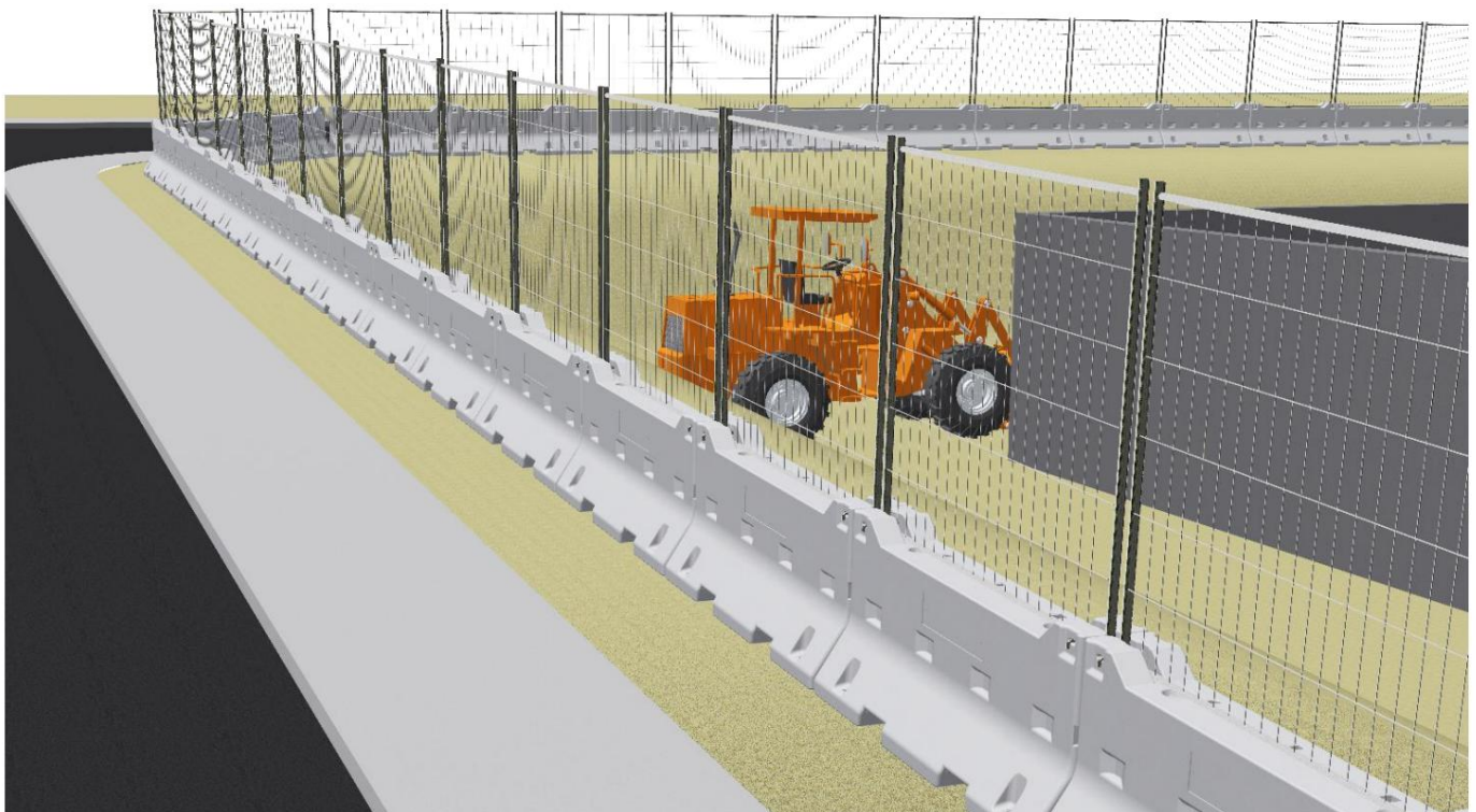
Fig. 5: Betonelementer med byggehegn 3B2023 som afspærring samt faldbeskyttelse samt forhindring af gennembrud med køretøjer
