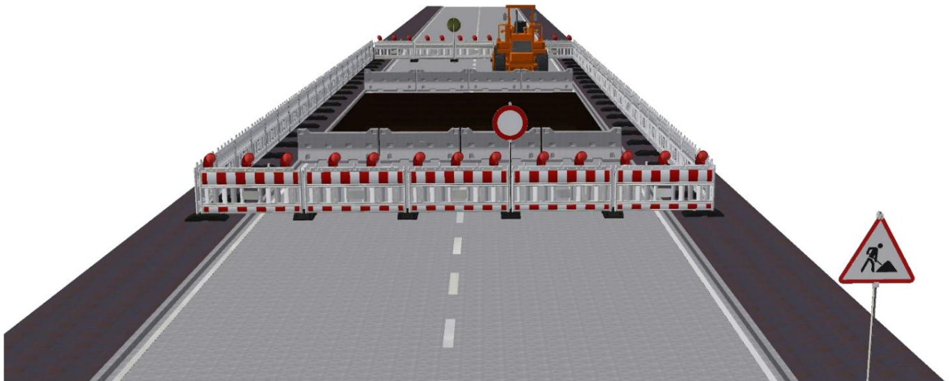
Fig. 4: Betonelementer ved vejlukning. Påkørselssikring med spærrebomme og advarselys
